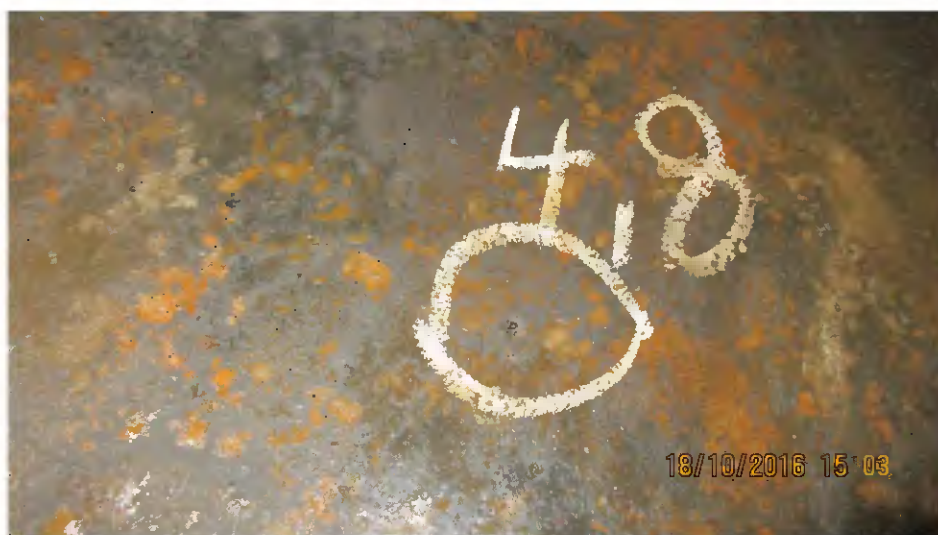
Slika 1. Točkovna zajeda v podnici rezervoarja
