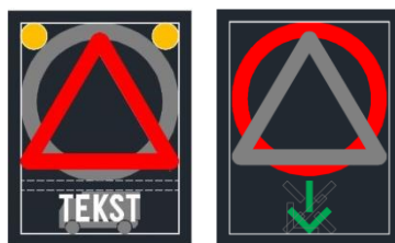
Slika 6: Oblika spremenljivega prometnega znaka (SPZ) Tip C
