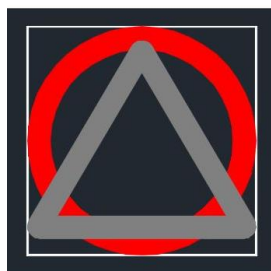
Slika 4: Oblika spremenljivega prometnega znaka (SPZ) Tip A
