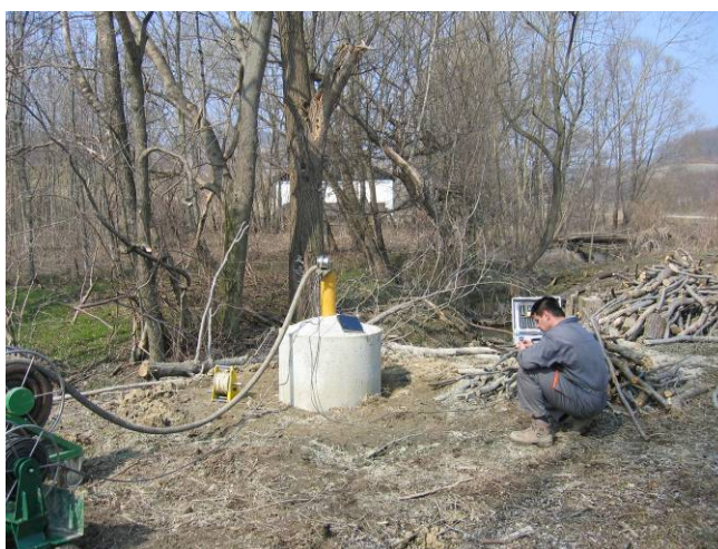
Slika 2.5.1.7.: Vrtina MEP-7 med črpnjem
