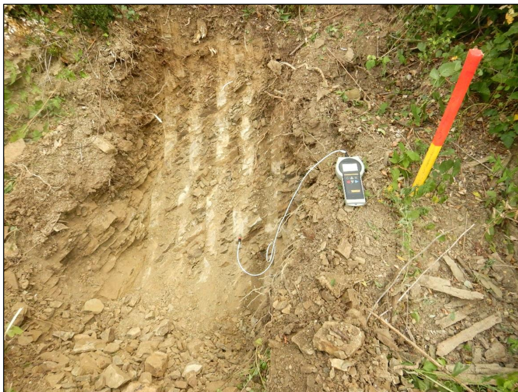
Slika: Lokacija jaška J1 – meritve toplotne prevodnosti v globini 0,30 m
