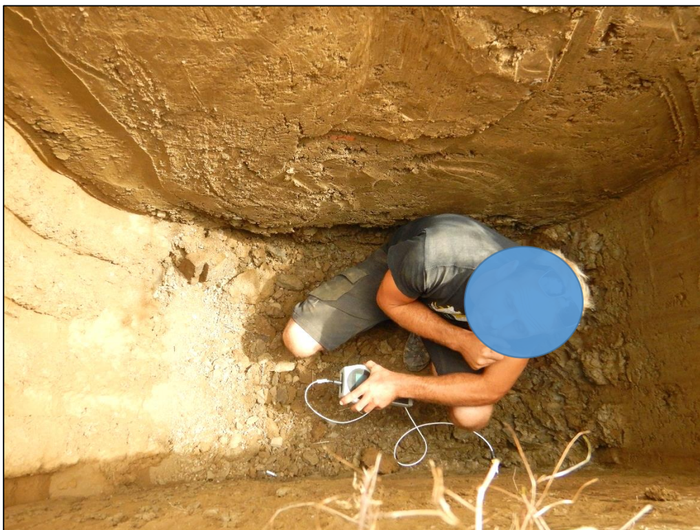
Slika: Meritve toplotne prevodnosti v globini 1,40 m (v meljih)
