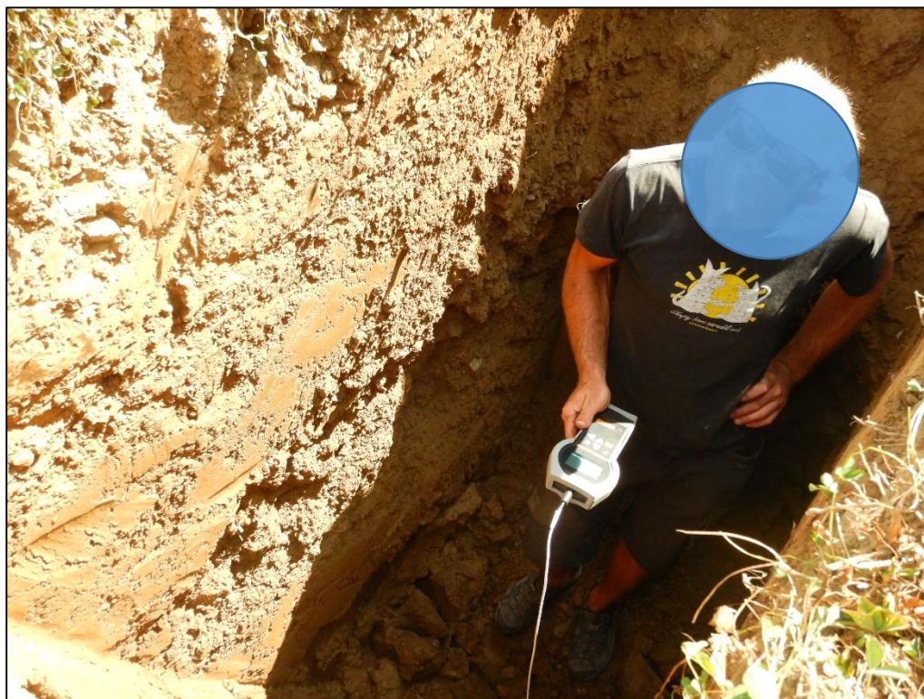
Slika: Meritve toplotne prevodnosti v globini 2,0 m
