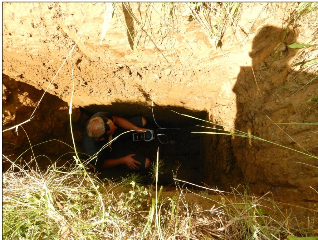
Slika: Meritve toplotne prevodnosti v globini 1,70 m
