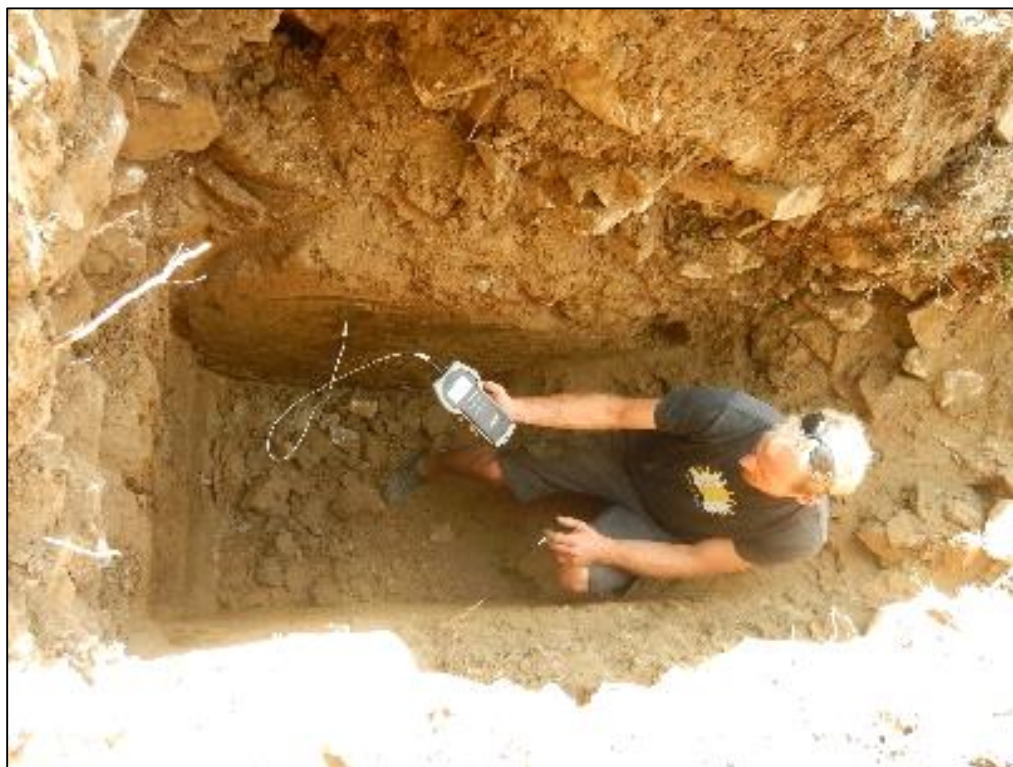
Slika: Meritve toplotne prevodnosti v globini 1,60 m
