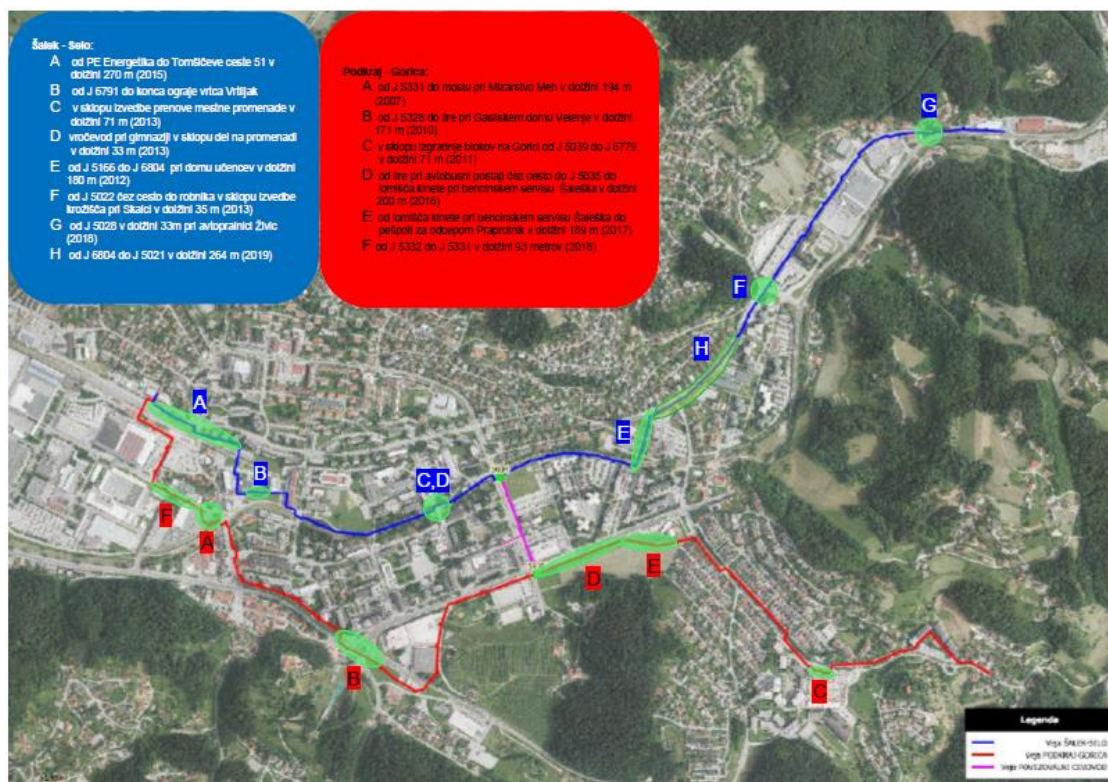
Slika 3: Distribucijsko omrežje Podkraj – Gorica in Šalek – (Vemont) Selo s prikazom že obnovljenih tras
