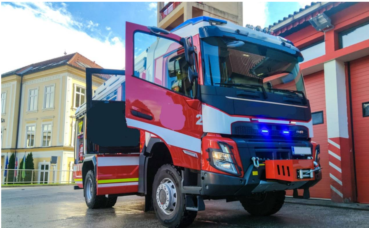
Slika 5: Kovinska zaščita vitla nameščena na tovornjak
