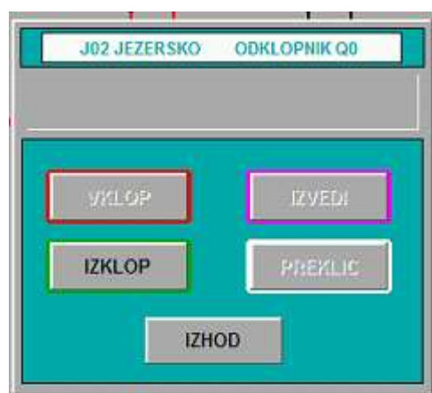
Slika 5: Princip organizacije okna za izvajanje stikalnih manipulacij
