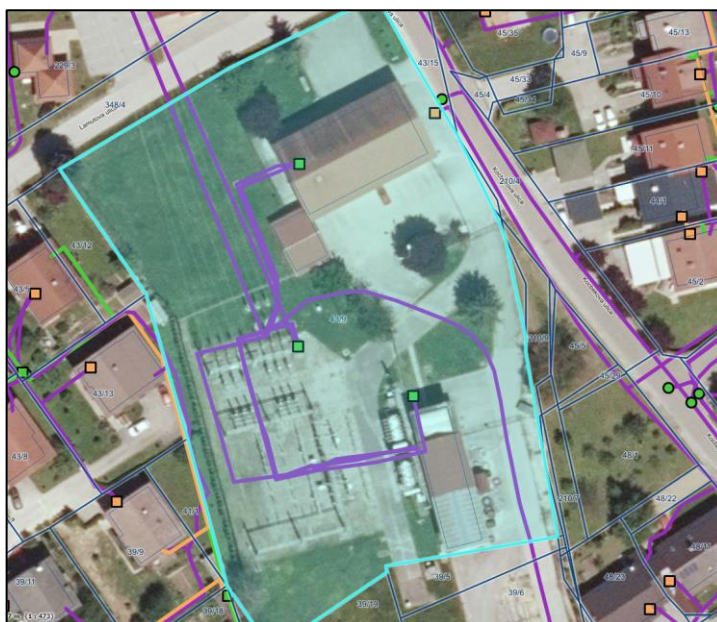
Slika 5: Potek optičnih vodov
