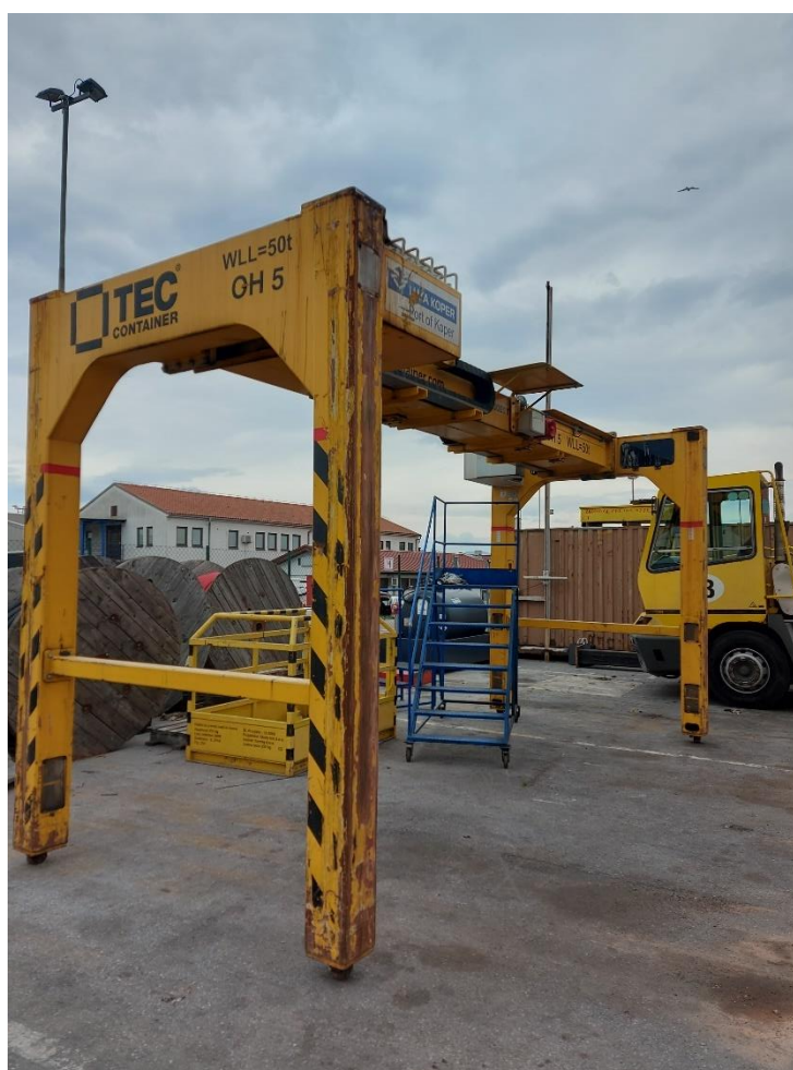
Slika 1: Prijemalo za izven gabaritne tovore (OH prijemalo)
