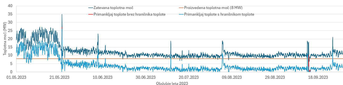
Slika 39: Zahtevana toplotna moč, proizvedena toplotna moč z 8 MW TČ ter primanjkljaj toplote, ki ga je potrebno nadomestiti z drugimi viri v letu 2023.
