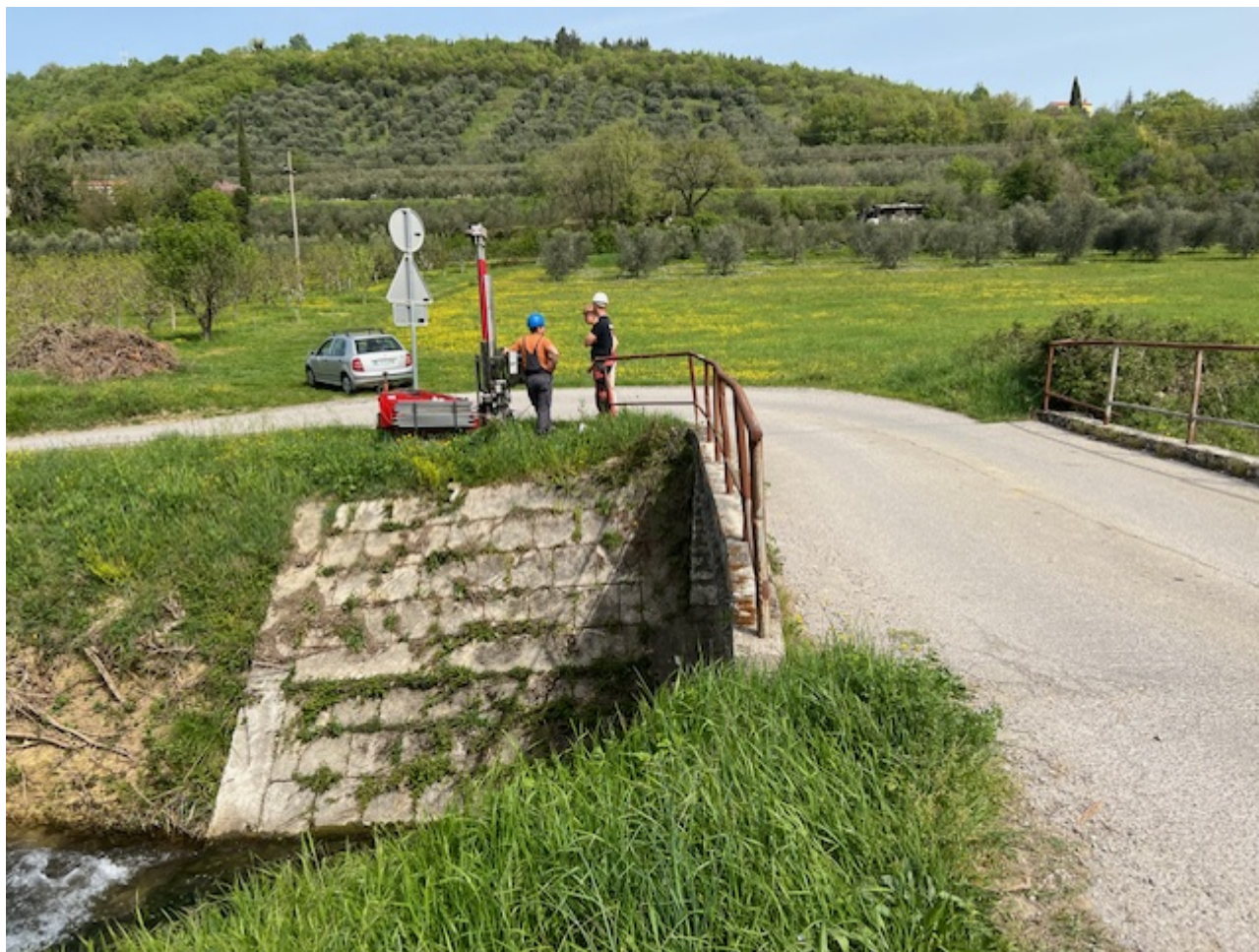
Slika 1: pogled na mostiček čez potok Drnica in izvedba statične penetracije
