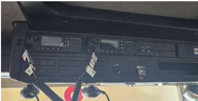
Slika 2: lokacija vgradnje radijskih postaj
