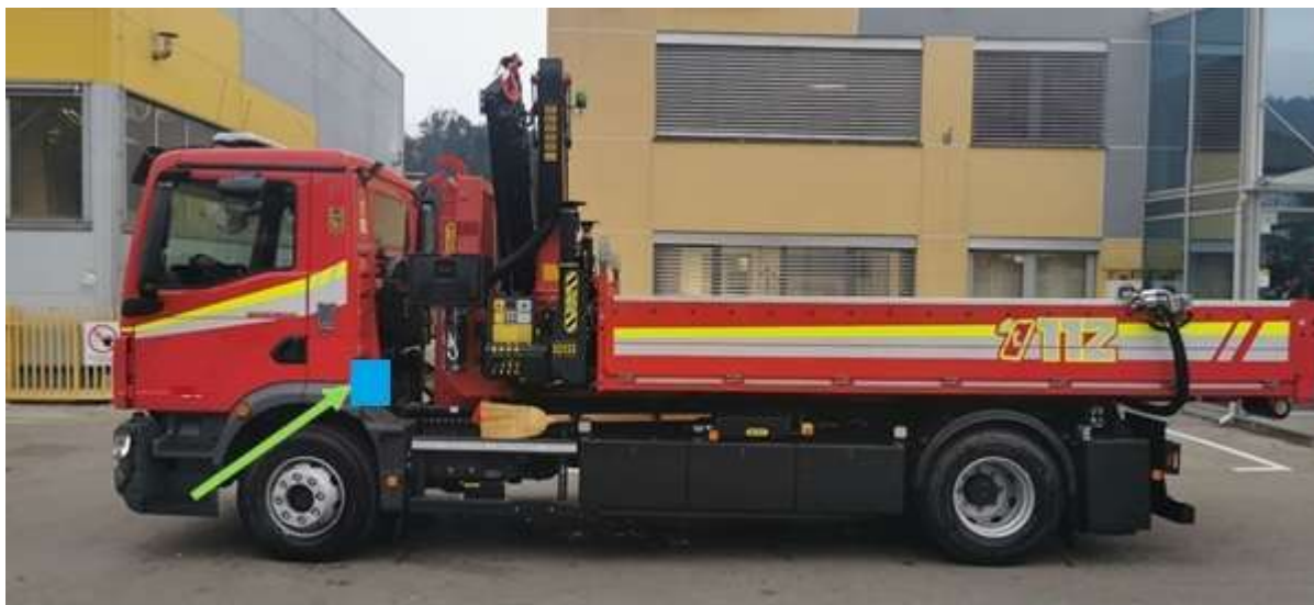
Slika 21: lokacija reflektorjev pod kabino za osvetlitev boka vozila
