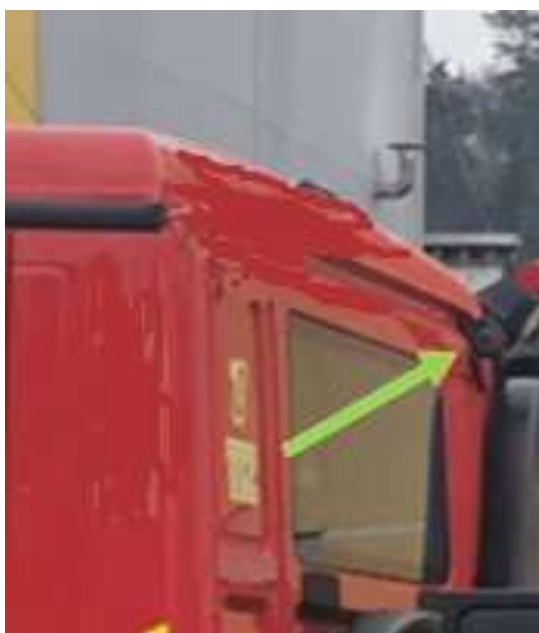
Slika 23: namestitev delovne LED luči zadaj
