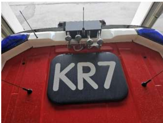
Slika 20: primer zaščite zračne sirene
