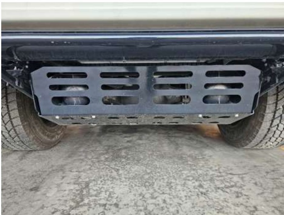
Slika 18: lokacija namestitve zvočnika elektronske sirene
