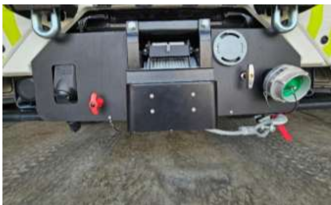
Slika 11: Primer vgradnje vitla ter odklopnega stikala
