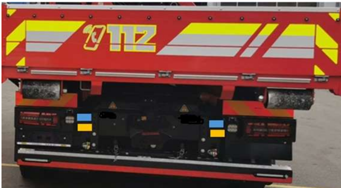
Slika 17: lokacija vgradnje LED bliskavic na zadnjem delu vozila
