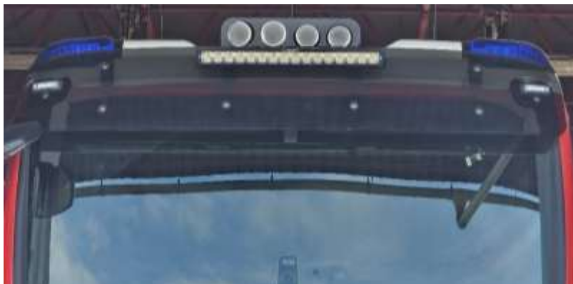
Slika 22: namestitev delovne LED luči spredaj
