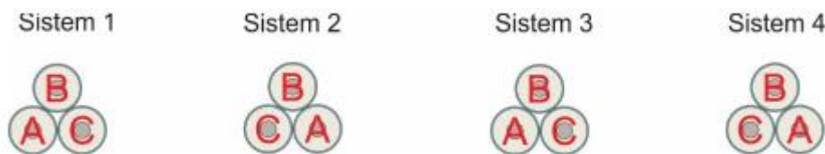
Slika 5: Večje število kabelskih sistemov v trikotni razporeditvi.
