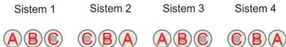
Slika 6: Večje število kabelskih sistemov v horizontalni ravninski razporeditvi.
