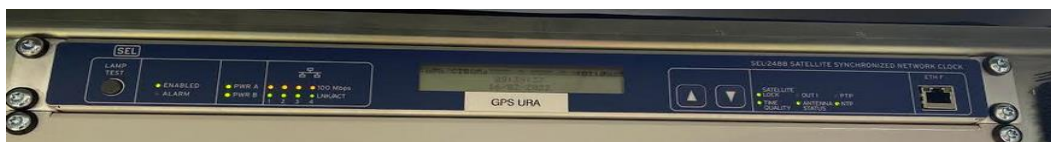
Slika 11: GPS sprejemnik točnega časa SEL-2488
